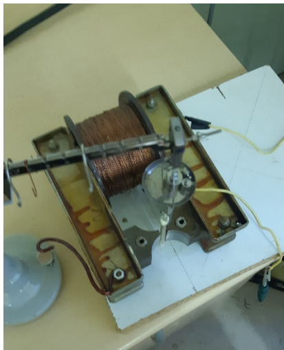
1. ábra. Az elektromágnes nagy indukciójú részének kialakítása
