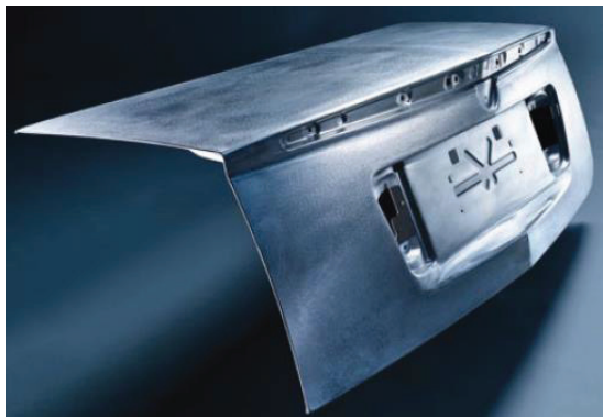
12. ábra. Cadillac STS gépjármű TopForm® SPF minőségű alumíniumötvözetből superképlékeny alakítással gyártott csomagtér ajtaja. [14]
