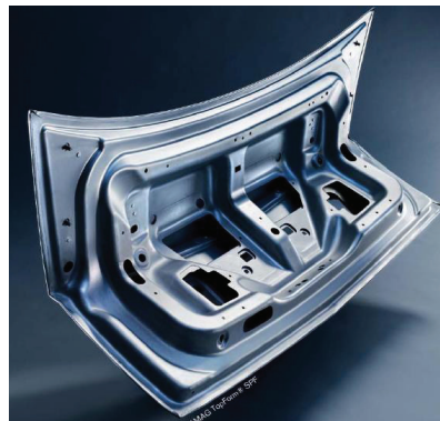
12. ábra. Cadillac STS gépjármű TopForm® SPF minőségű alumíniumötvözetből superképlékeny alakítással gyártott csomagtér ajtaja. [14]
